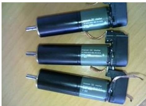
图 72 直流有刷电机 MAXON
